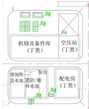
罐区及围堰设置情况示意图
